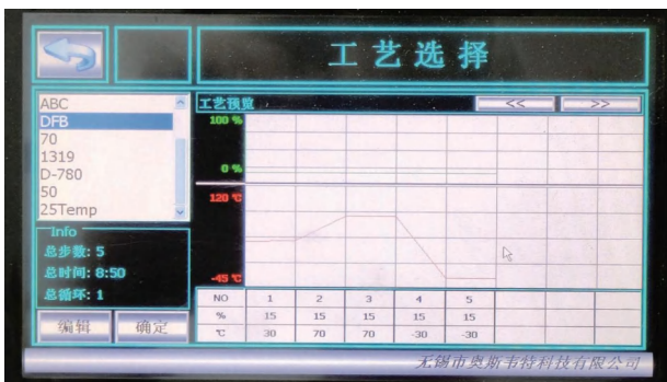
高低温存储试验, -30°C~70°C, 试验后可以正常工作
