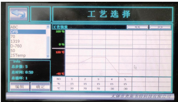
高温存储试验, -30°C~70°C, 试验后可以正常工作
