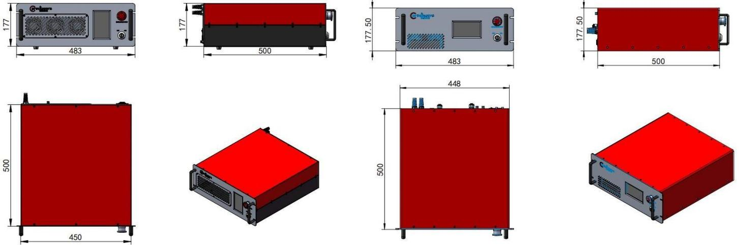
拉曼机箱尺寸图-风冷
